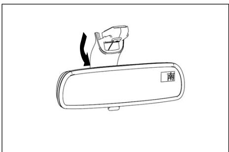
(b) 沿前挡风玻璃的表面往下滑动，取下内后视镜总成。
