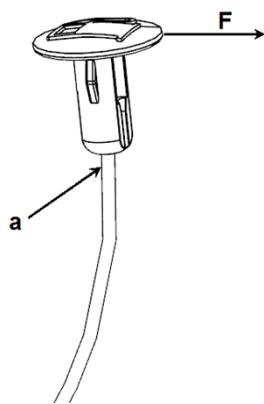
沿着下图中 f 力的方向，将一个金属小薄片插入执行器锁止结构下面，将锁止结构从地槽中解锁出来。然后用平口镊子（或者金属片）插入 a 点撬执行器，即可将执行器从油箱口底座上翘起来。拔出执行器，取掉接插件后，完成对油箱口执行器的拆卸。安装过程与之相反。
