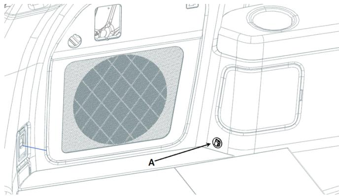
然后拿着应急解锁手柄 a 所示位置，沿着下图示中手柄缺口位置用力将应急手柄头掰下。
